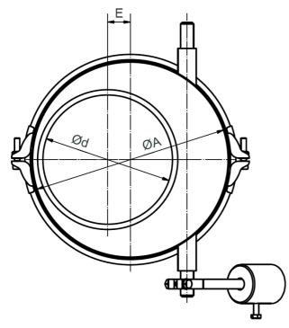
Rohrdurchmesser- und Rundheitstoleranz nach DIN EN 10296-1 Längen und Winkelmaße – DIN ISO 2768-1 – Toleranzklasse V
